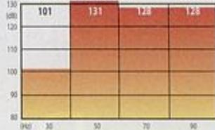
Neuer Pegelrekord bei 50 Hz, Messung bei 50 Hz und 70 Hz durch Kompression (>3 dB) begrenzt.
